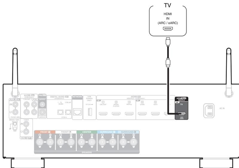
\* Pour les téléviseurs 4K, nous recommandons d'utiliser un câble HDMI étiqueté "High Speed" et "with Ethernet".
